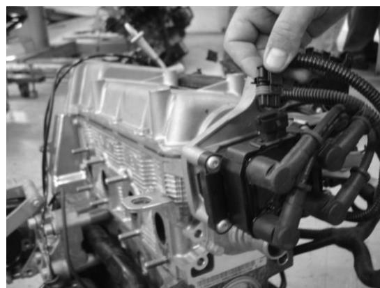
Bobina dupla que equipa os GM Celta e Vectra. Possui 3 fios, portanto não tem módulo de potência interno e deve ser utilizada com uma SparkPRO-2.
