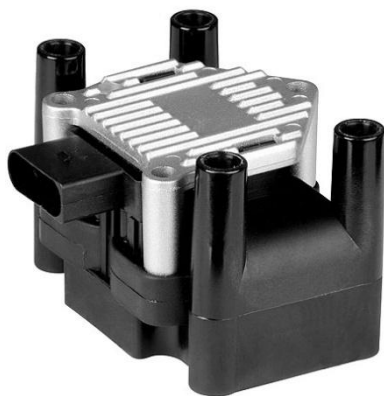
Bobina Dupla que equipa alguns VW Golf, Bora, Audi A3 e A4. Possui módulo integrado e é acionada por 5V.
